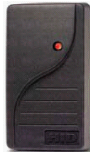
Figura 2 – Leitor de proximidade de curto alcance
